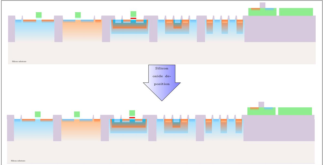
**Figure 28:** Oxide layer
